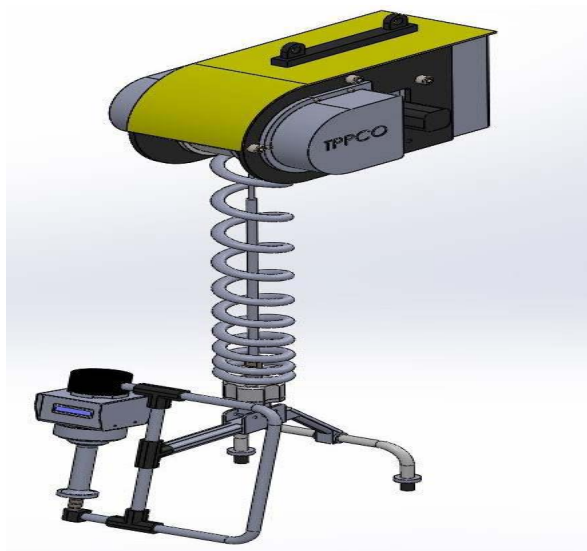
شکل 5 - شماتیک اسمارت لیفت و گریپر
